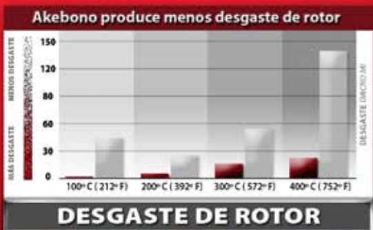
Desgaste del rotor después de 1,000 frenadas - Prueba en el BMW Serie 3 ■ EURO de Akebono ■ Proveedor de Equipo Original
